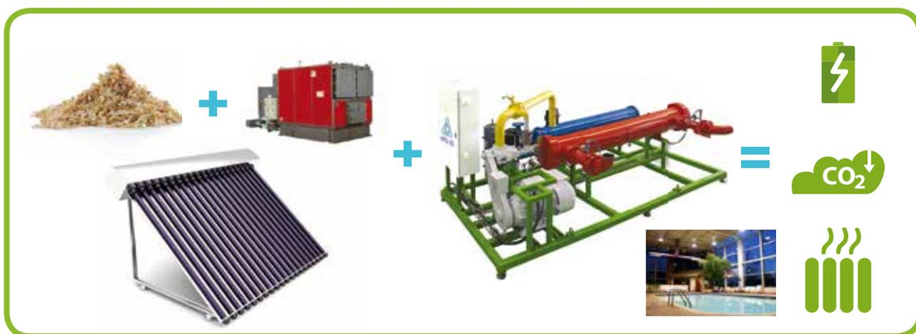
Si bien el rendimiento eléctrico del sistema se mantiene en los órdenes de cualquier Ciclo Rankine Orgánico, la energía térmica disponible en el condensador es íntegramente aprovechada para conseguir la temperatura deseada en la climatización de la piscina, incrementando la eficiencia global del sistema hasta los valores asociadas a cogeneraciones.
